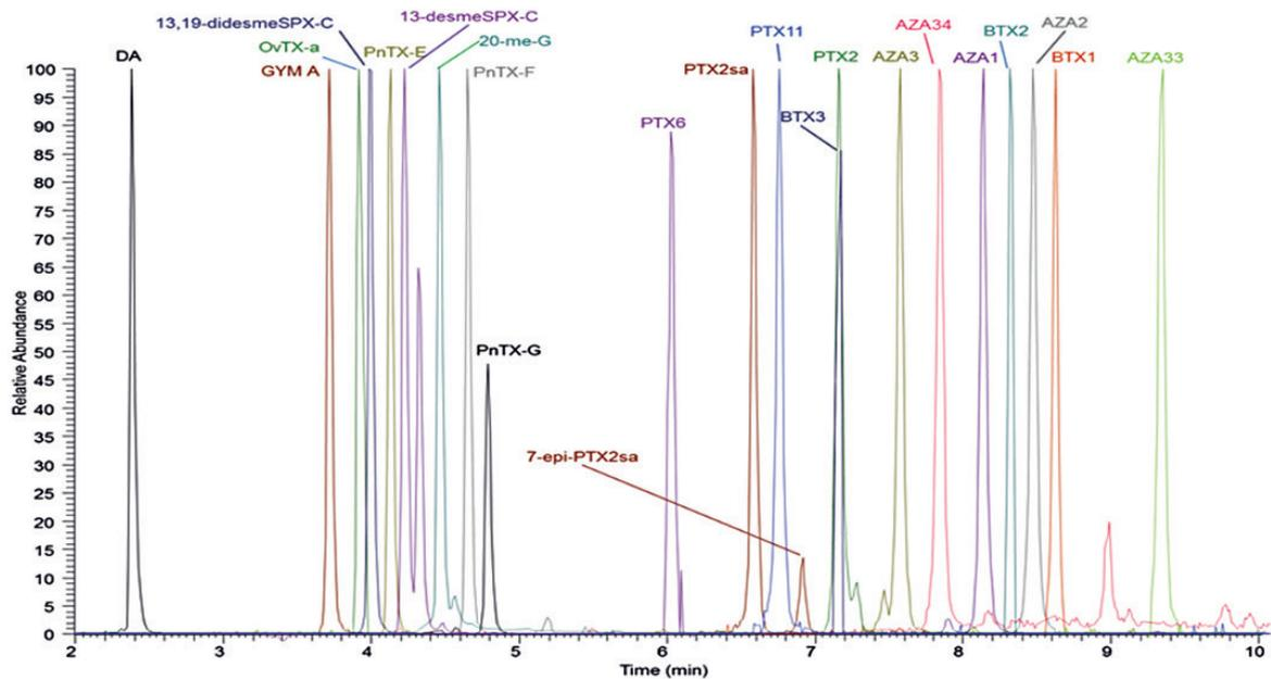
Figure 7. Séparation chromatographique des toxines lipophiles connues par la méthode d'analyse non-ciblée basée sur la spectrométrie de masse haute résolution.
